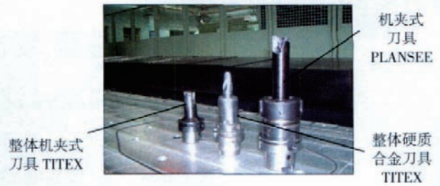
图6 零件加工使用的典型加工刀具 Fig.6 Typical machining tools of NC milling
